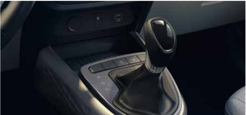
Cambio automatico Il cambio manuale automatizzato a cinque marce unisce la guida facile e rilassata del cambio automatico ad una maggiore efficienza, grazie al peso inferiore e all'attrito ridotto rispetto a un cambio automatico tradizionale.
